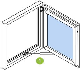
Der Öffnungsbegrenzer ① begrenzt den Öffnungswinkel des Drehflügels auf 90°. Er vermindert die selbständige Bewegung des Elementflügels bei Zugluft. Der Öffnungsbegrenzer ist wartungsfrei und darf nicht geölt werden.
