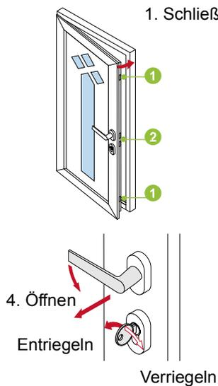
Diese Verriegelung weist zusätzlich Riegelfallen **1** im oberen und unteren Bereich des Türflügels auf.
