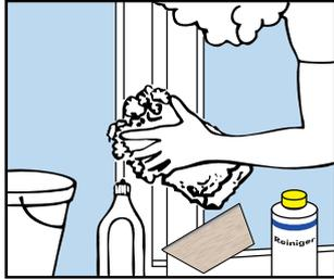
Die optimale Fensterpflege erreichen Sie, wenn Sie die Fensterrahmen und Dichtungen bei jeder Scheibenwäsche reinigen. Verwenden Sie hierzu ein mildes, scheuermittelfreies Reinigungsmittel.
