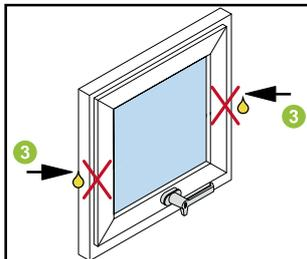
Alle beweglichen Teile der Beschläge Ihrer Schüco Elemente sind nahezu wartungsfrei. Doch ein wenig säurefreies Öl und Fett halten die Mechanik leichtgängig und sichern den Bedienkomfort über einen langen Zeitraum. Sprühen Sie die Schließzapfen und die Lagerpunkte der Kippschere mit dem Ölspray aus dem Schüco Pflegesortiment ein.
