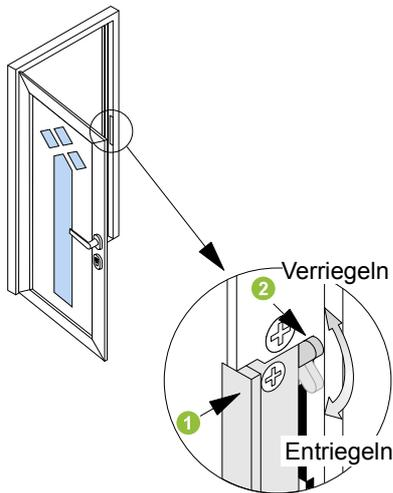
Die geschlossene Tür wird durch einen separat angebrachten Schalter zum Öffnen freigegeben. Die freigegebene Tür kann nur solange geöffnet werden, wie der Schalter betätigt wird.
