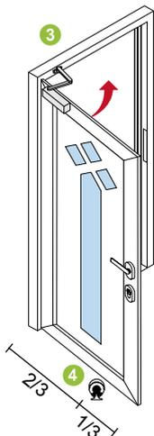
Der Türschließer **3** bewegt den Türflügel automatisch in die geschlossene Stellung zurück. Einige Türschließer halten den Türflügel in geöffneter Stellung ganz auf. Zum Schließen muss die Tür einmal in Schließrichtung gezogen werden, danach schließt sie wieder automatisch.
