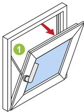
Die Zuschlagsicherung ① hemmt das selbständige Zuschlagen des gekippten Elementflügels. Dadurch wird eine Beschädigung des Elementes durch heftiges Auf- oder Zuschlagen des Flügels bei Zugluft verhindert. Die Zuschlagsicherung ist wartungsfrei.
