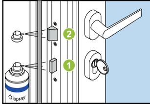
Bei Türen muss der Riegel **1** und die Falle **2** des Türschlosses den Anforderungen entsprechend gefettet werden.
