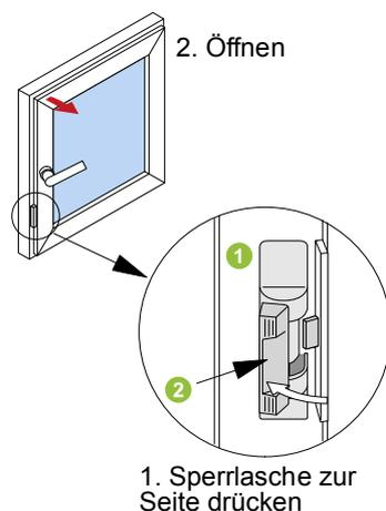
Der aufliegend angebrachte Spaltlüfter ① begrenzt die Dreh- und Kippstellung des Elementflügels auf eine Spaltöffnung.
