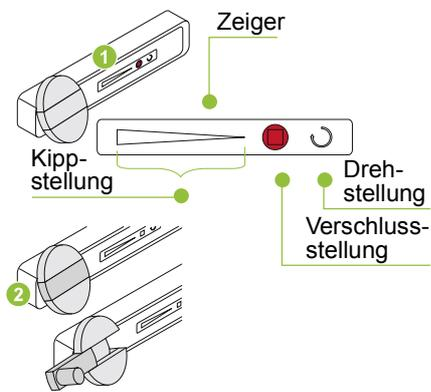
Das Kurbelgehäuse ist mit einer Positionsanzeige **1** versehen. Der rote Zeiger zeigt an, in welcher Stellung sich der Beschlag befindet.
