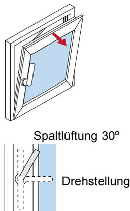
Der Mehrfachspaltlüfter ① begrenzt die Kippstellung des Elementflügels in 4 verschiedenen Spaltöffnungen.
