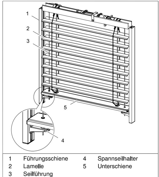
Abb. 1: Teileübersicht windstabiler Raffstore (abgebildet E 93 A6 windstabil)
